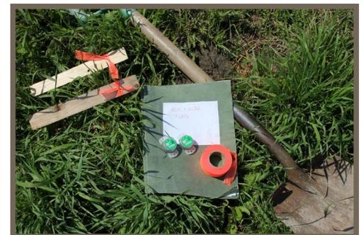
Photo 2. Les enregistreurs de température HOBO Pendant® MX avant d'être enterré à 5 cm sous la surface du sol dans une parcelle témoin labourée et une parcelle de traitement sans labour avec tissu couvre-sol.
